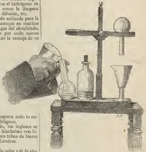
Fig. 4. Fabricación de los balones de colodión
